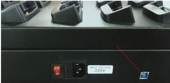
**Obs.** Para melhor performance, conecte a DMT8C em uma porta USB 3.0 na estação de trabalho
